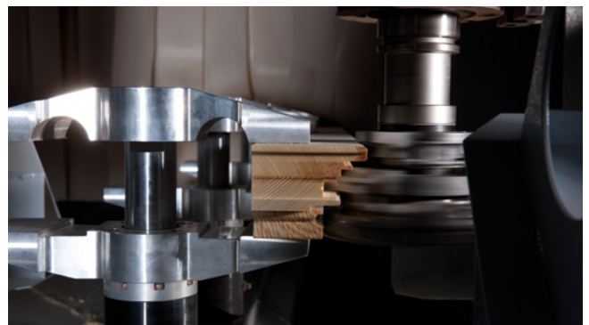
Kvapalinou chladené frézovacie vretená s vektorovou reguláciou
