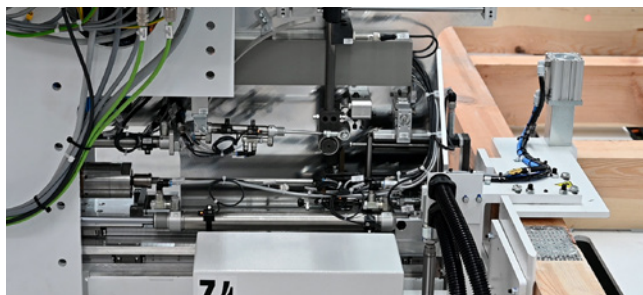
Skrutkovací agregát na skrutkovanie priečkových konštrukcií.
