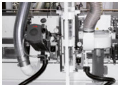
Aggregateführungen mit hochpräziser Einstellvorrichtung und schwenkbaren Hochfrequenzmotoren
