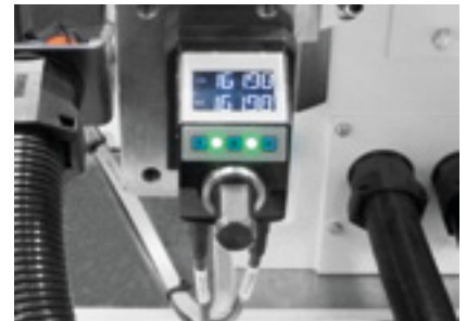
Digitalanzeige mit Sollwertvorgabe für präzise und einfache Verstellung
