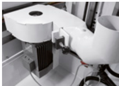
Jeder Motor mit einer an das Werkzeug angepassten Absaughaube
