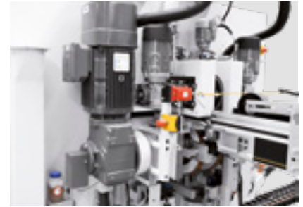
Frequenz- oder servogeregelte Antriebe sorgen für konstanten Vorschub bei jeder Geschwindigkeit bei TENONTEQ D-600 (Querbearbeitung optional)
