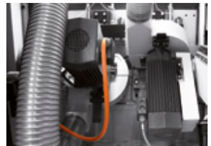
Schwenkbare Hochfrequenzmotoren mit Einzelabsaugung
